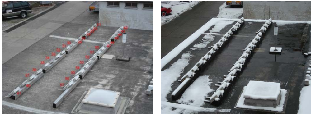
Bild 5.5 Auslagerung der Verbundkörper auf dem Dach der Forschungsstelle.
